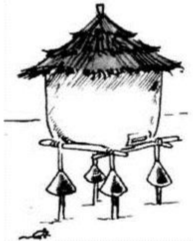
Protection métallique contre les rats
