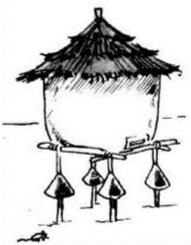
Protection métallique contre les rats
